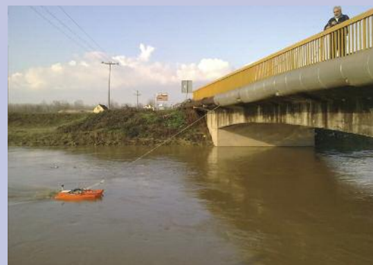
Хидрометријско мерење ADCP уређајем Hydrometric measurement by ADCP instrument
